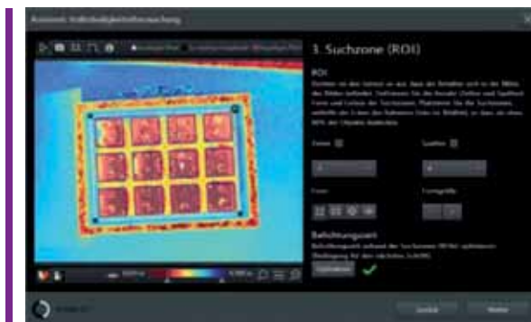
Figura 2. Gracias a una aplicación programable, es posible determinar el volumen de objetos rectangulares en tecnologías de transporte y almacenamiento
