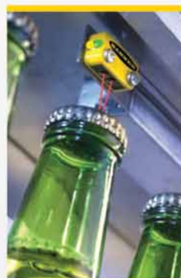
Inspección de tapas en espacios reducidos
