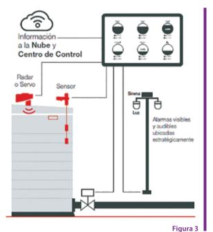
una señal continuamente, mostrando que el dispositivo está funcionando correctamente o si hay algún problema con el switch. Esto permite un testeo continuo, mientras que los sensores tradicionales son testeados cada seis meses típicamente. API recomienda el uso de sensores con autodiagnóstico.
