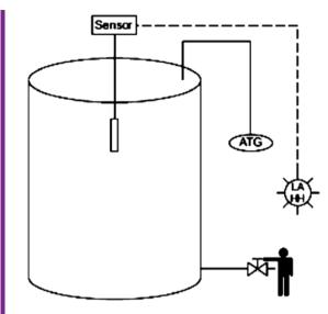
Figura 1. Sensor ATG independiente de alarma
