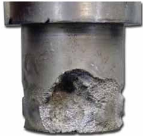
Figura 1. Un ejemplo del daño causado por cavitación
