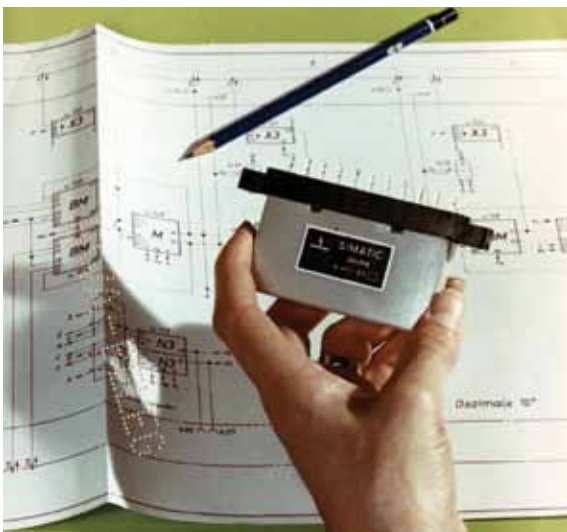
Modulo de Simatic G de primera generación construido con Germanio
