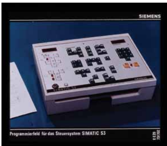
Equipo de programación de los Simatic S3 . Aproximadamente, 1973
