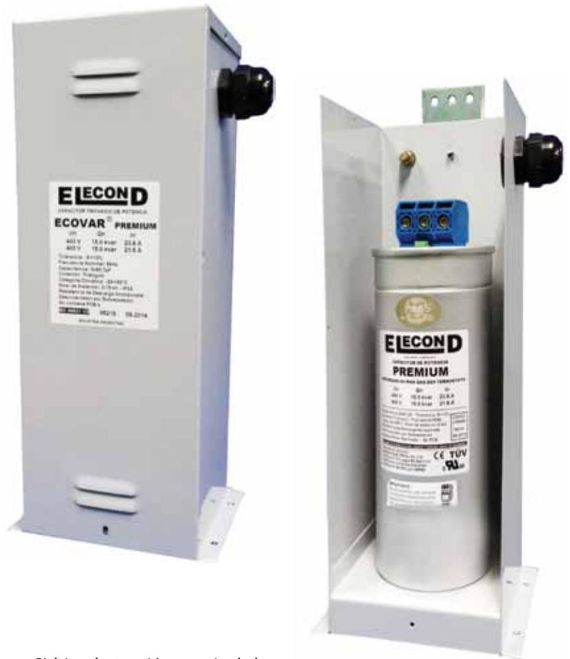
Si bien la tensión nominal de ambos capacitores es de 440 V, equivalente a 400 V reforzados, cabe destacar que un capacitor de tensión nominal 440 V usado a 400 V tiene 83% de su potencia nominal pero tiene mayor resistencia a las sobretensiones y extiende su vida útil un 50%.
