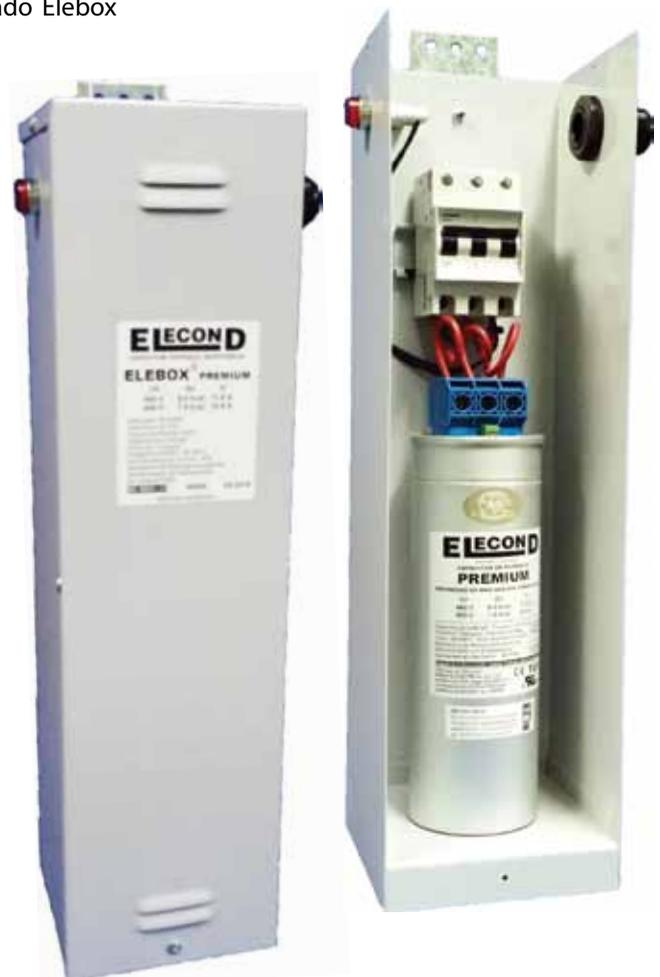
y ensamblado con capacitores trifásicos Elecond Premium certificados UL810 y con desconectador por sobrepresión (DSP) y dieléctrico reforzado, impregnado en gas inerte, libre de PCB, con resistencias de descarga y con una tensión nominal de 440 V equivalente a 400 V reforzados.
