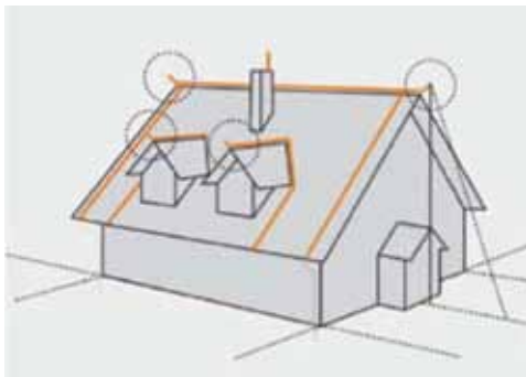
Figura 6 – Conductores de bajada.
