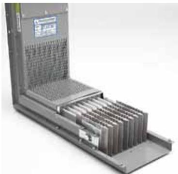
Se proporciona el sistema de la línea *MV* eléctrica prefabricada para corrientes nominales de 630 a 6.000 amperes con barras conductoras de aluminio o cobre, conductores en baja tensión (hasta un kilovolt). Tiene cajas de derivación *plug-in* hasta 800 amperes para permitir la inclusión de diversos sistemas de protección, tales como disyuntores, seccionadores o fusibles. El grado de protección del bus ventilado *MV* es IP 31.
