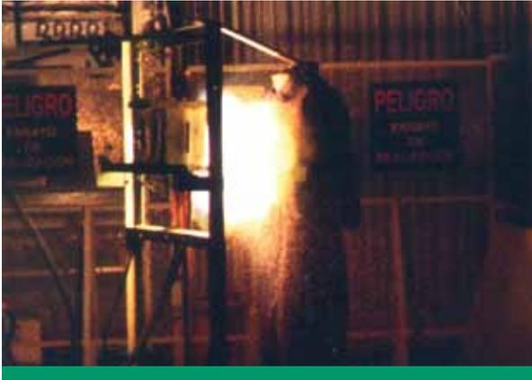
generado por una corriente entre dos electrodos, montados en una caja de yeso diseñada ad hoc. La configuración de prueba hace que el arco se expanda solo en una dirección, en la cual se coloca la muestra de ensayo.
