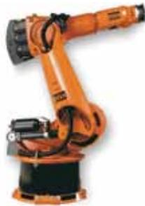
Poseen seis ejes en total, el último especialmente diseñado para la rotación continua, lo cual permite suprimir la marcha hacia atrás hasta la posición inicial, reduciendo tiempo de mecanizado.
