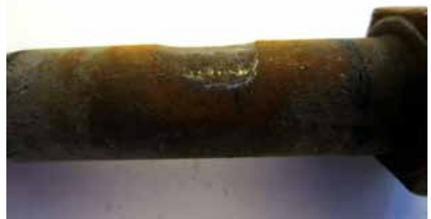
Figura 5. Abrasión en el perno de la AGS
