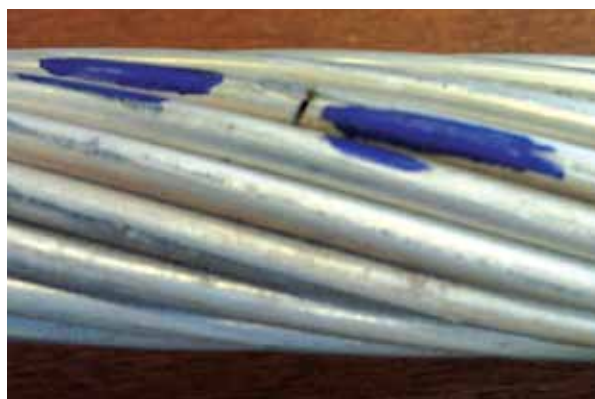
Figura 1. Hebra rota en la capa exterior del conductor
