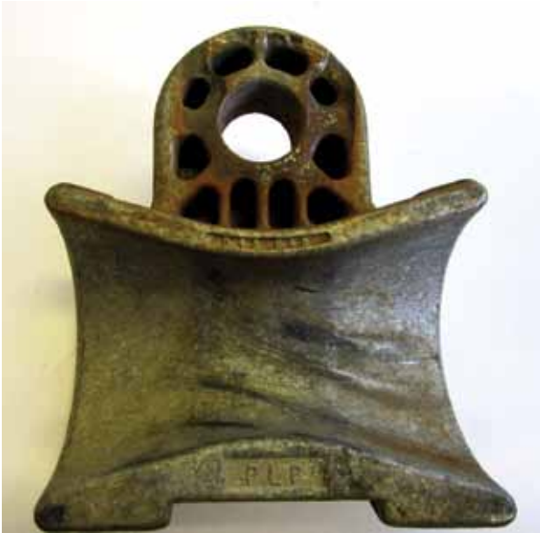
Figura 4a. Desgaste de la carcasa AGS
