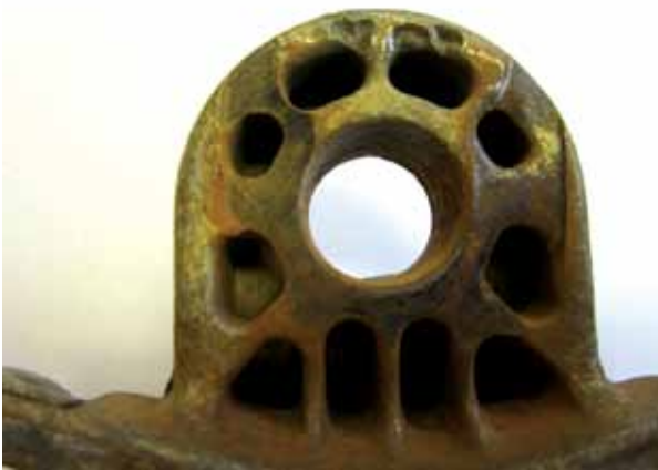
Figura 4b. Desgaste de la carcasa AGS (de cerca)
