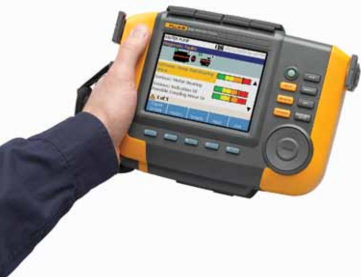
máquina a lo largo del tiempo con el estado inicial correcto. Los analizadores de vibraciones que se emplean en los programas de supervisión basados en las condiciones de funcionamiento dependen de los estados iniciales para poder evaluar el estado de la máquina y determinar su vida útil restante.
