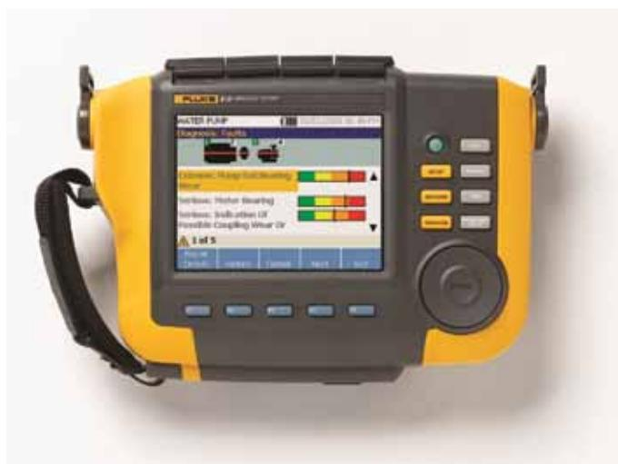
El analizador portátil Fluke 810 se ha diseñado y programado para diagnosticar los problemas mecánicos más comunes de desequilibrio, holgura, alineación incorrecta y fallos en los rodamientos de una amplia variedad de equipos mecánicos, entre los que se incluyen motores, ventiladores, cintas y cadenas de transmisión, cajas de cambios, acoplamientos, bombas, compresores, máquinas con acoplamiento compacto y husillos.
