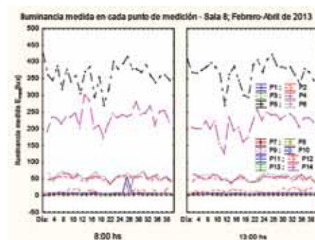
Figura 6. Variación de la iluminancia medida ( E_{med}[lux] ) por cada punto de medición entre las 8:00 y las 13:00 horas
