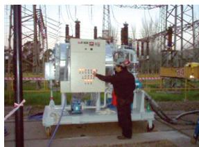
**Análisis, tratamiento y llenado de aceite:** para el tratamiento integral del aceite dieléctrico, dispone de varias plantas de filtrado con un caudal máximo de 6.000 l/h. *Nova Miron* también cuenta con equipo de aire seco, plantas de aplicación de alto vacío y cisternas para el almacenamiento de grandes volúmenes de aceite, además de personal altamente calificado y profesional para la gestión del servicio.
