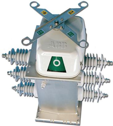
El seccionador bajo carga *Sectos* es un equipo para montaje en poste aislado en gas SF<sub>6</sub> aplicable en alimentadores de distribución, líneas aéreas convencionales y también del tipo *BLX* con conductores aislados. Su diseño está orientado al telecontrol de sistemas de automatización en distribución.
