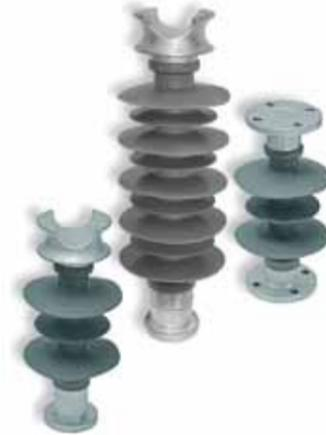
El aislador tipo soporte de 15 kV cuenta con dos alas grandes y una chica. La distancia de fuga es de 380 mm y la de arco, 165. Otras características técnicas son los hasta 12 kN de carga mecánica y las tensiones resistidas: 95 kV ante impulso atmosférico seco. Por su parte, el de 35 kV cuenta con cinco alas grandes y cuatro chicas. La distancia de fuga es de 900 mm y la de arco, 286. La carga mecánica es de 10 kN, y sobretensiones resistidas: 170 kV ante impulso atmosférico en seco.
