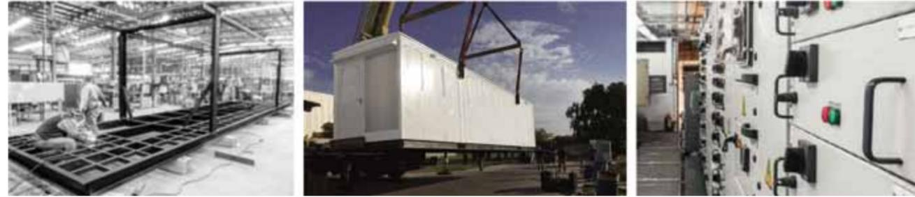
Se desarrollan centros transportables para instalación intemperie. Se emplean como subestaciones transportables para distribuir la energía eléctrica en media y baja tensión.
