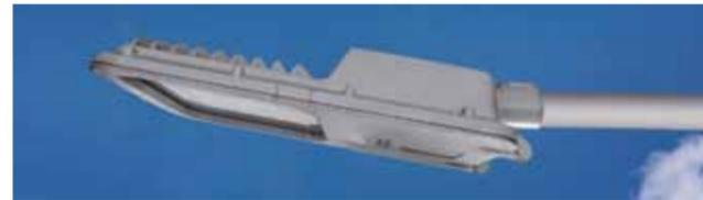
RS 320 Led se presenta con 6, 8, 10 módulos o mixdeal, tipo FX220 o FF, con 72 a 160 leds en total. La potencia va de 166 a 338 W según el modelo; la corriente, 0-700 mA, y el flujo luminoso, 12.304 a 31.500 lm. El equipo mide 970 mm de largo, 390 de ancho y 110 de alto y se puede montar tanto horizontal- como verticalmente (40 o 60 mm).
