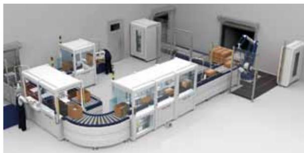
Dependiendo de la aplicación, se utilizan para proteger puntos de operación, zonas peligrosas y perímetros. Sus aplicaciones más comunes son estaciones de robot, cabinas de soldadura, prensas, plegadoras, cortadoras, punzonadoras, paletizadoras, máquinas eléctricas, sistemas de transporte, etc.
