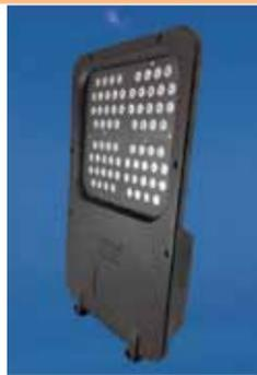
El proyector presenta con dos o cuatro módulos tipo FX115, con 36 o 72 leds en total. La potencia con dos módulos es de 83 W, con cuatro, de 143; la corriente, 0-600/0-700 mA, y el flujo luminoso, 6.921 o 13.842 lm. El equipo mide 575 mm de largo, 312 de ancho y 93 de alto y se monta con gancho trolley.
