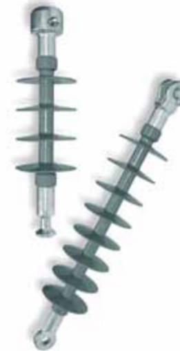
Ambos modelos están contruidos según la normativa específica IEC 61109 y cuentan con núcleo poltruido de fibra de vidrio y resina epoxi, revestidos de un compuesto de silicóna que aporta hidrofobicidad, resistencia a la contaminación, alta rigidez dieléctrica y bajo nivel de radiointerferencia.
