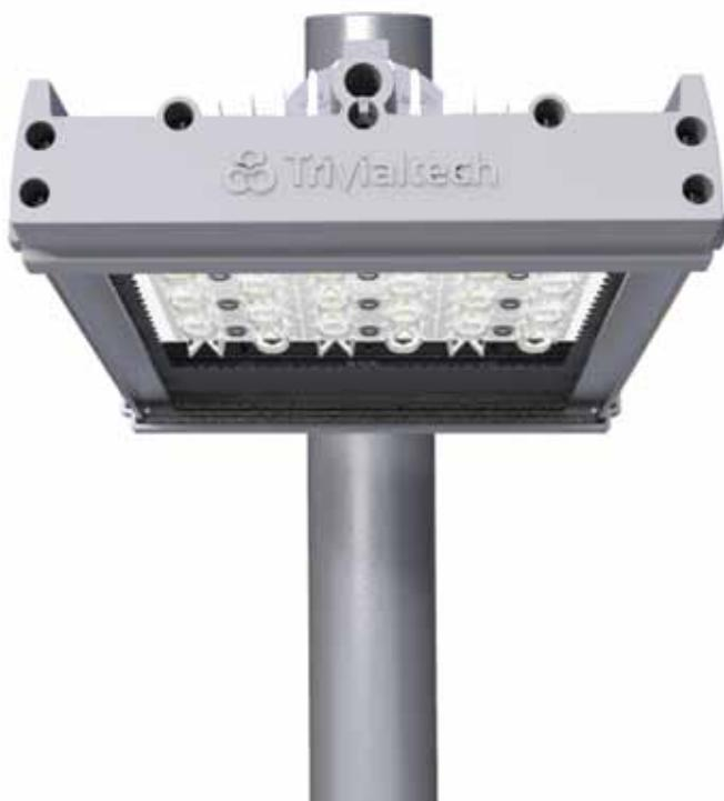
Construida por un cuerpo principal de aluminio extruido, obtiene su hermeticidad de grado de protección IP 66 gracias al cierre lateral de dos tapas con burletes de goma siliconada. Aloja dentro todo el poder de la tecnología de placas de led de *Trivialtech*, que funcionan directamente alimentadas con tensión de red de 220 volts sin la utilización de fuentes o drivers que ya han probado su utilización libre de fallas por más de 50.000 horas de uso continuo.
