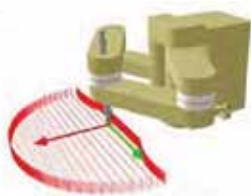
Robot SCARA (del inglés a Selective Compliant Assembly Robot Arm o Selective Compliant Articulated Robot Arm ) es un robot de cuatro grados de libertad con posicionamiento horizontal
