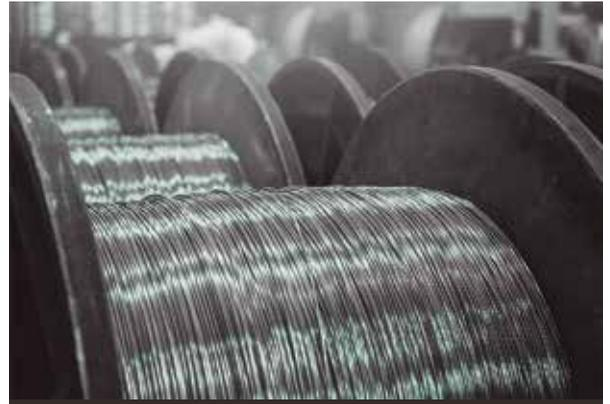
El trefilado es un proceso de conformación que consiste en la reducción de sección de un alambre de aluminio, de cobre, de acero o de latones, en general.
