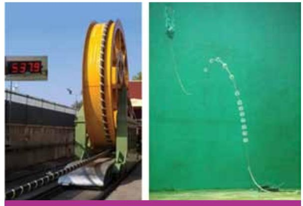
Figura 3. Ejemplos de testeo a escala completa de cables submarinos de aguas profundas (fuente: *paper Jicable 2019-A5.6*) y para aplicaciones dinámicas (fuente: *paper Jicable 2019-C8.3*)
