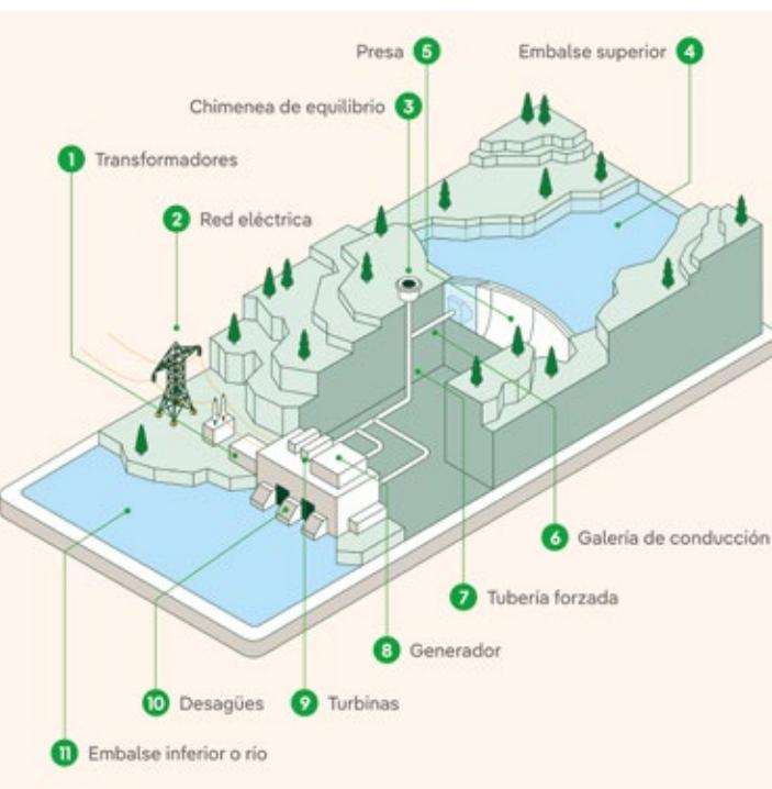
Partes de una hidroeléctrica de bombeo
