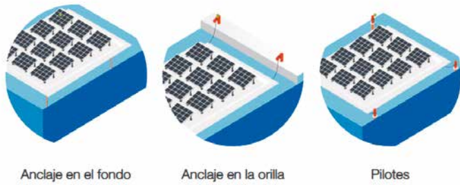
Fondeo y anclajes
