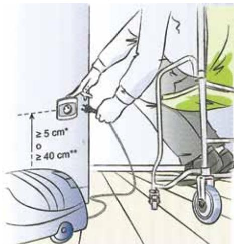
Figura 1. Conexión de una alimentación (\*NFC15-100, \*\*DGHUC N° 2007)
