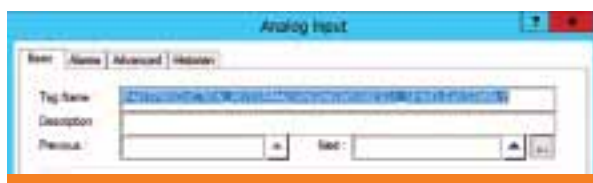
Figura 4. La longitud de los tags y las descripciones aumenta de treinta a 256 caracteres
