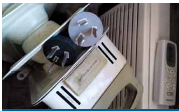
5. "Al revés del pepino": el acondicionador, de bajo consumo, vino con ficha de veinte amperes (20 A), mientras que el calefactor, de mayor consumo, vino con ficha de diez amperes (10 A)
