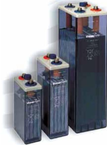
mecánicos, admite la colocación de una planta de energía sobre ella mediante una base adaptadora. También con tecnología tipo VRLA, con capacidad de 225 a 1.360 Ah. Las rejillas están fabricadas en un material aleación entre plomo y calcio, el contenedor y la tapa son de polipropileno con retardante de llama. Diseño antisísmico para zona 4, con sistema de postes deslizantes.
