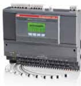
Arc Guard System™, el último monitor de arco de ABB, detecta rápidamente una falla de arco y abre el interruptor de entrada. Con la luz como criterio principal de activación, Arc Guard System™ se activa instantáneamente. Gracias a esta ventaja funcional clave, sobrepasa todas las demás protecciones y demoras, lo cual es un factor crucial cuando los tiempos de reacción se deben medir en milisegundos, protegiendo eficientemente a las personas y equipos.
