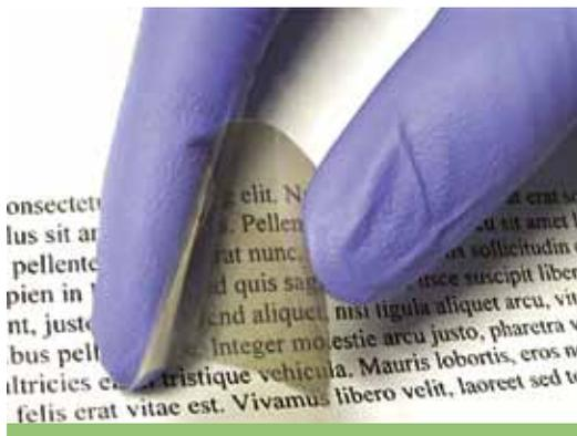
Con este material, además, es posible recubrir las superficies de plástico que después se instalan en las ventanas, en lugar de aplicarlo directamente sobre el cristal como se hacía hasta ahora. Para ello basta con revestir el plástico con una solución líquida de este material y después sumergir el conjunto en un compuesto con ácido, describe Milliron. Todo lo anterior —en particular el hecho de no necesitar elevadas temperaturas— facilita y abarata el proceso de fabricación.
