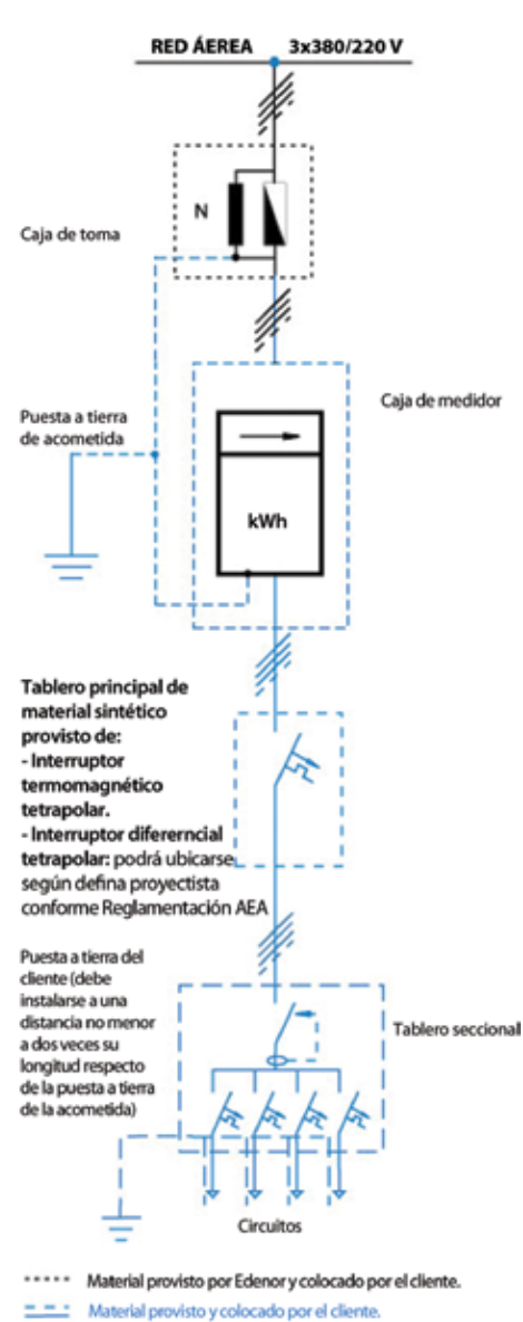
Esquema unifilar para acometida desde red aérea
