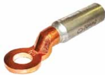
Figura 2. Terminal aluminio-cobre, también se puede usar terminal de aluminio interponiendo arandela bimetalica
