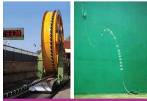
Figura 3. Ejemplos de testeo a escala completa de cables submarinos de aguas profundas (fuente: paper Jicable 2019-A5.6) y para aplicaciones dinámicas (fuente: paper Jicable 2019-C8.3)
