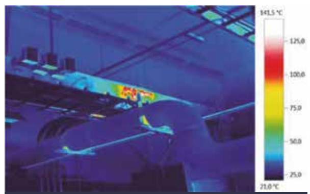
Cojinete recalentado de una calle de transporte
