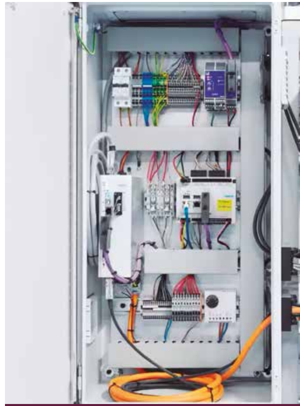
Todo bajo control en el conjunto de servoprensas YJKP: controlador CECC-X y controlador del motor CMMP, inclusive software de aplicación.
