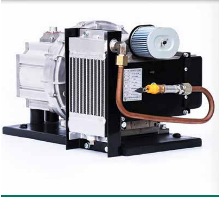
Figura 4. Ejemplo de un compresor de aire Scroll Air End, 2.2 kW, 3 Hp, 100% libre de aceite 250L/Min, 8.8 CFM, concentrador de oxígeno, 0.6-1.2 Mpa (6-12 bar)
