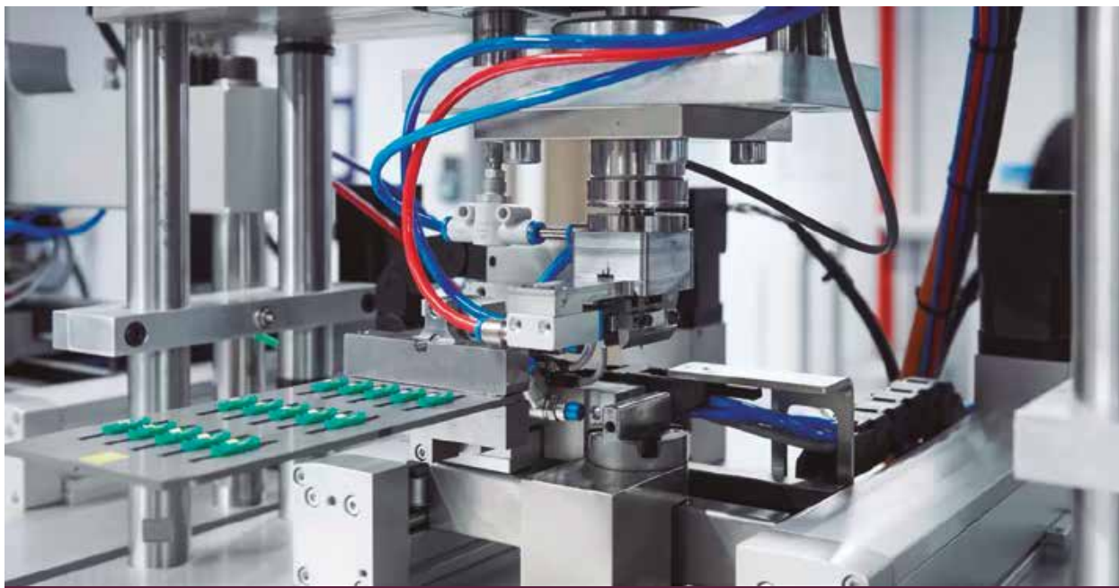
El sistema de manipulación compacto YXMx se ocupa de los movimientos XY de las piezas bajo la servoprensa.
