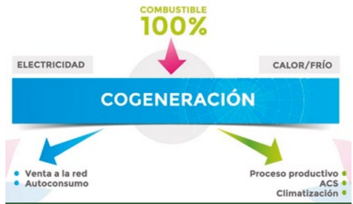
Figura 4. Central térmica de trigeneración
