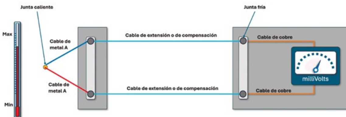
Figura 7. El efecto Seebeck en una termocupla realizando la medición de temperatura
