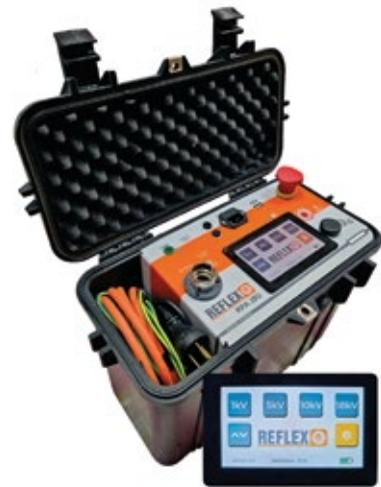
El probador de aislamiento RPA 25D es un generador de alta tensión autónomo que funciona con baterías recargables, fabricado por Reflex, empresa argentina.
