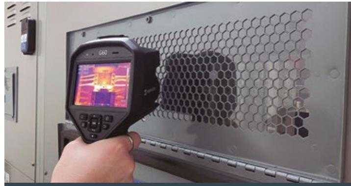
Las ventanas de inspección por infrarrojos son un método de seguridad que las industrias están adoptando. Permiten realizaciones de control del mantenimiento en dispositivos eléctricos y energizados, sin correr riesgos de explosiones de arco eléctrico y otros imprevistos. Son parte de los EMDS, dispositivos de seguridad para el mantenimiento eléctrico que, junto con otros equipos, innovan en el método de inspecciones y mantenimiento preventivo.
