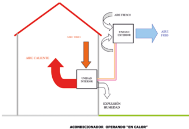
Figura 4. Esquema de un aire acondicionado operando "en calor"
