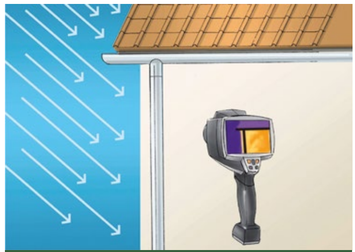
Figura 1. Reflexión en mediciones en exteriores
