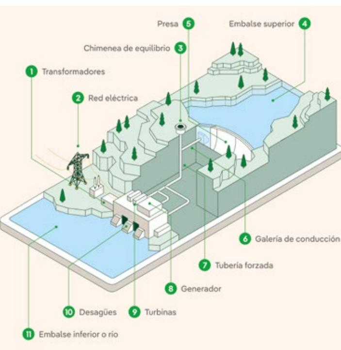
Partes de una hidroeléctrica de bombeo
