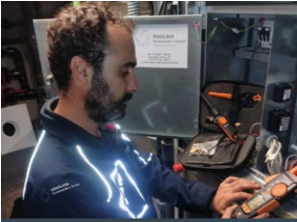
La pinza amperimétrica testo 770-3 es un instrumento de gran utilidad para determinar el rendimiento energético de los equipos.
