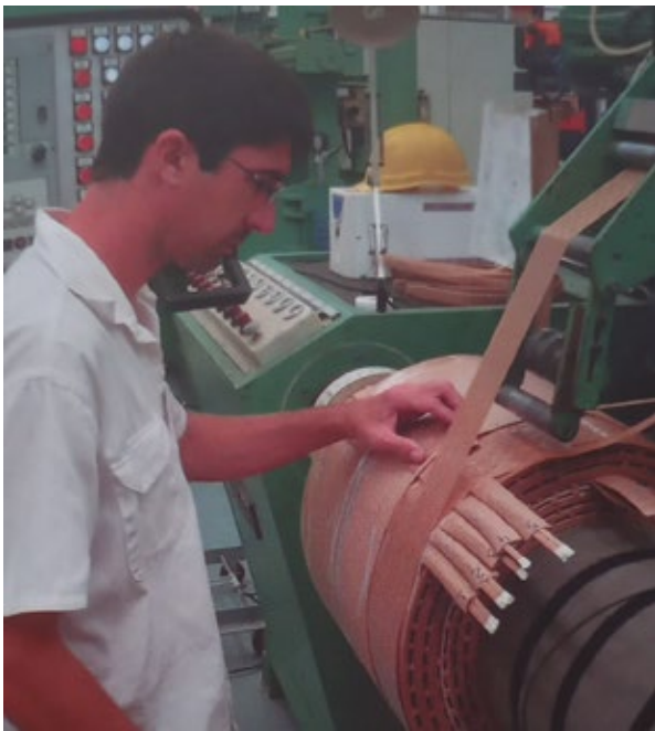
Figura 1. Fabricación de arrollamientos de media y alta tensión con maquinaria automatizada
