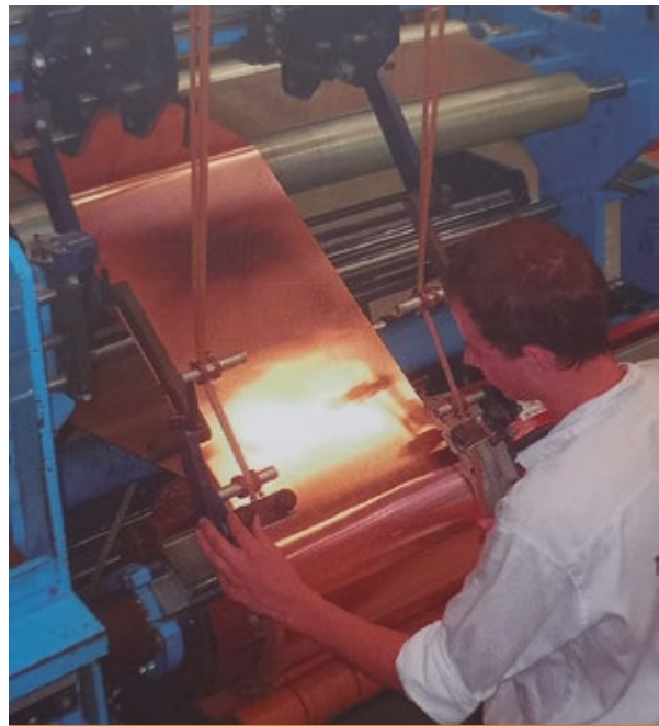
Figura 2. Arrollamientos en base a folios de cobre electrolítico puro
