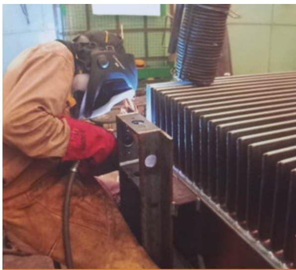
Figura 3. Soldadores certificados se encargan de las soldaduras en las cubas aletadas cuando el pedido supera la potencia estándar de 1.250 kVA
