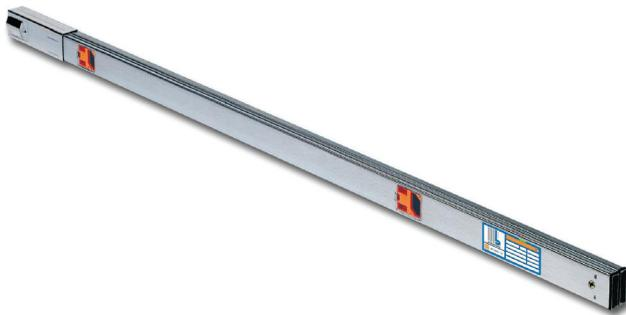
se proporciona prefabricado para corrientes nominales de 160 a 800 amperes con aluminio o cobre, conductores en baja tensión (hasta un kilovolt). Tiene accesorios enchufables hasta 800 amperes para permitir la inclusión de derivaciones y diversos sistemas de protección. El grado de protección del bus blindado *MB* es IP 54.
