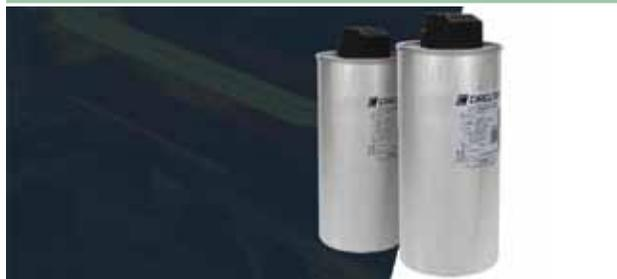
Condensadores autorregenerantes con dieléctrica de polipropileno de bajas pérdidas, sin impregnantes líquidos. Disponen de un sistema de desconexión por sobrepresos, que desconecta el condensador en caso de algún tipo de fallo interno.
