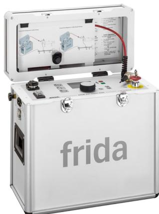
**Frida:** VLF para cables hasta 20 kV y ensayo de cubiertas.
