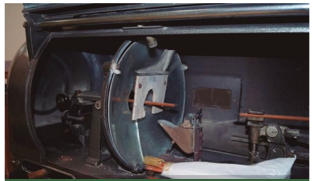
Lámpara de arco de proyección unidireccional. Se utilizó hasta la década de los '70 para proyección de cine y seguidor en el teatro. Se observan ambos electrodos de grafito cobreado en periferia y el espejo parabólico. El punto de ignición debe permanecer en el foco de la parábola.
