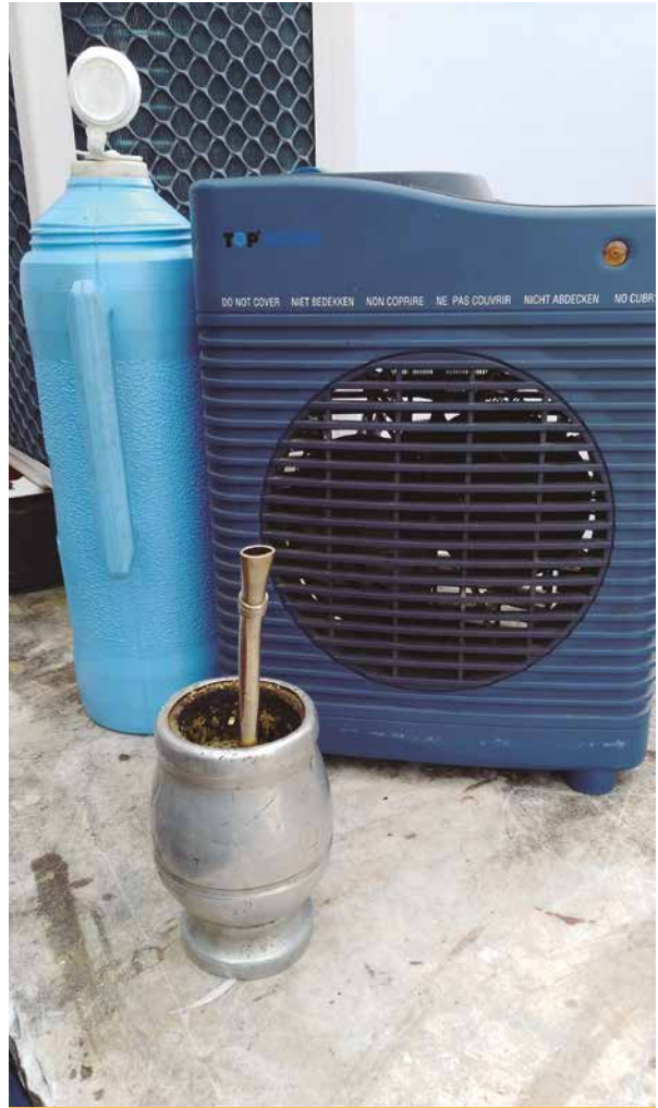
Caloventor de 2 kW (¡2 kW dentro de una cajita plástica de unos 15 x 22 x 10 cm!)
