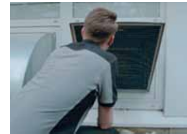
Figura 1. a) Si se cubre la salida de aire con el cuerpo, se modificará la resistencia del caudal y de este modo se distorsiona el resultado de medición.
