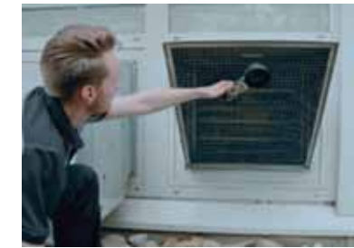
b) Para medir correctamente, la salida de aire solo se cubre con el brazo y el instrumento de medición de modo que el aire pueda fluir sin impedimentos.
