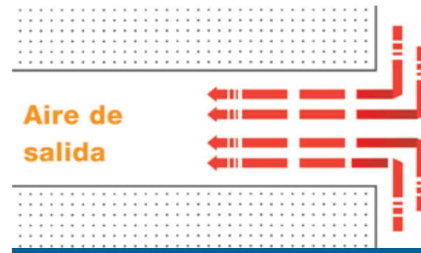
Figura 4. En las salidas de aire de escape se succiona el aire desde todas las direcciones. Para generar una corriente de aire que se pueda medir es necesario utilizar un cono.
