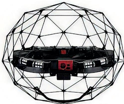
Figura 4. El dron de mapeo 3D de Flyability
