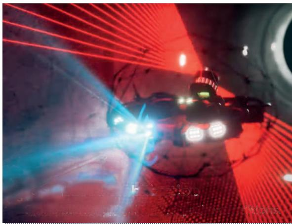
Figura 3. El dron Elios-3 utilizando su sistema LIDAR
