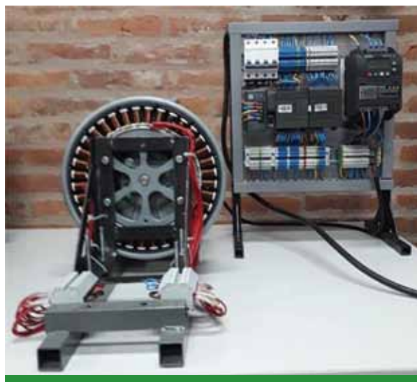
Figura 5. Tablero de control y banco de ensayos del generador eléctrico
