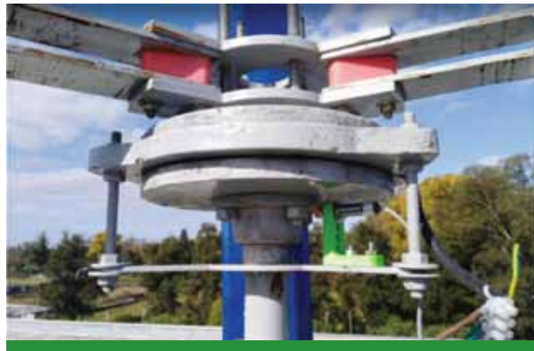
Figura 2. Acople entre los brazos de las palas al generador eléctrico
